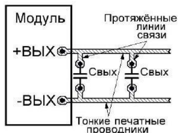
Рисунок 7.3 – Пример правильной разводки проводников печатной платы
