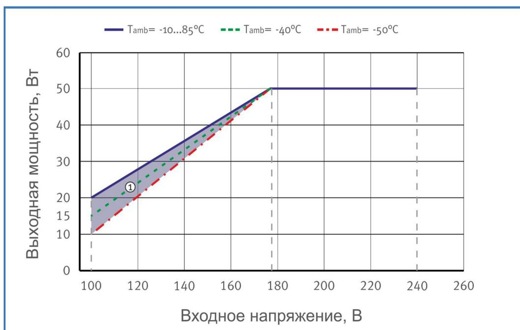
① - Для диапазона температуры окружающей среды  $-50^{\circ}\text{C}...-10^{\circ}\text{C}$  серым цветом выделена область режимов работы, при которых возможно отклонение некоторых параметров модуля от норм, приведенных в настоящем документе.
