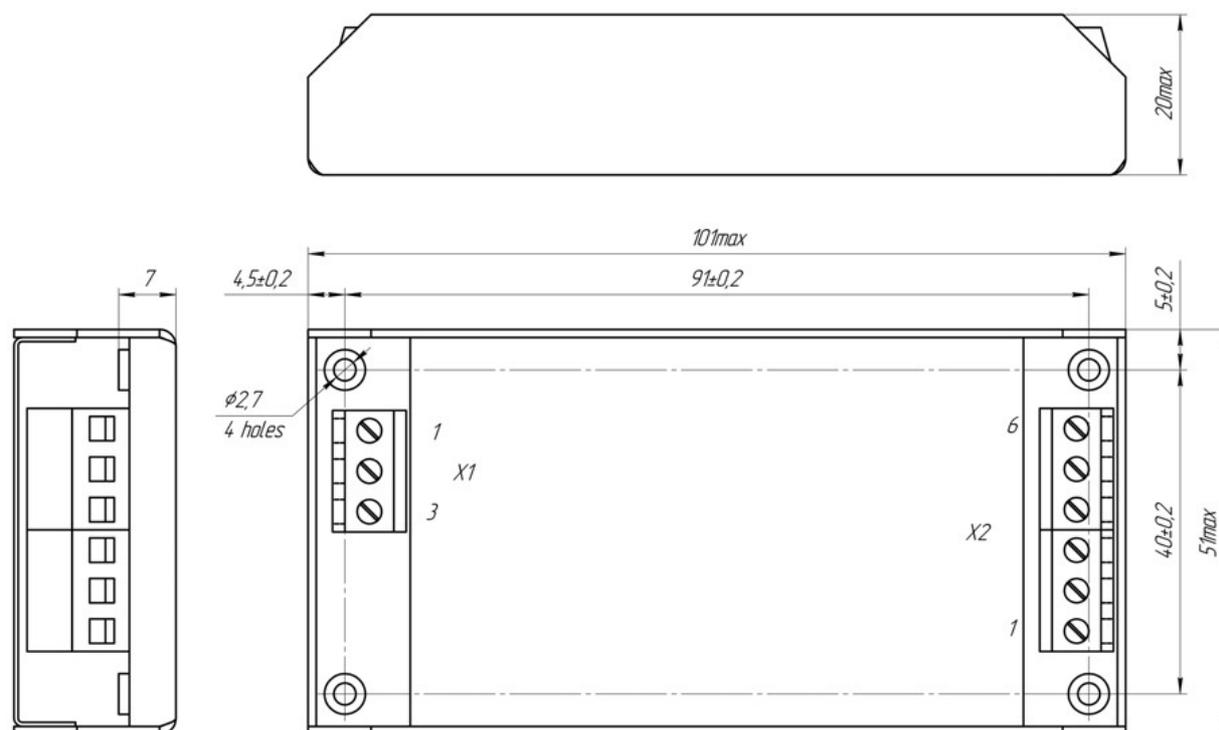
**Вариант исполнения корпуса с клипсой типа EN50022-35x15/7.5
